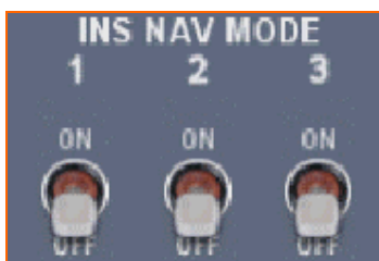
2. Sélecteur INS de mode de navigation en configuration triple
